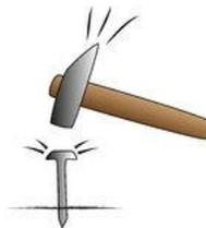
Pour enfoncer un clou avec un marteau, il faut se mettre bien au-dessus du clou, et taper le plus droit possible, pour ne pas tordre le clou. Il faut aussi taper fort, pour que le clou puisse s'enfoncer.
